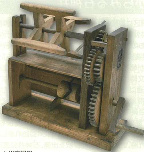
上州座繰器 取っ手を回すと歯車の作用で、繭から生糸を取ることができる道具。
